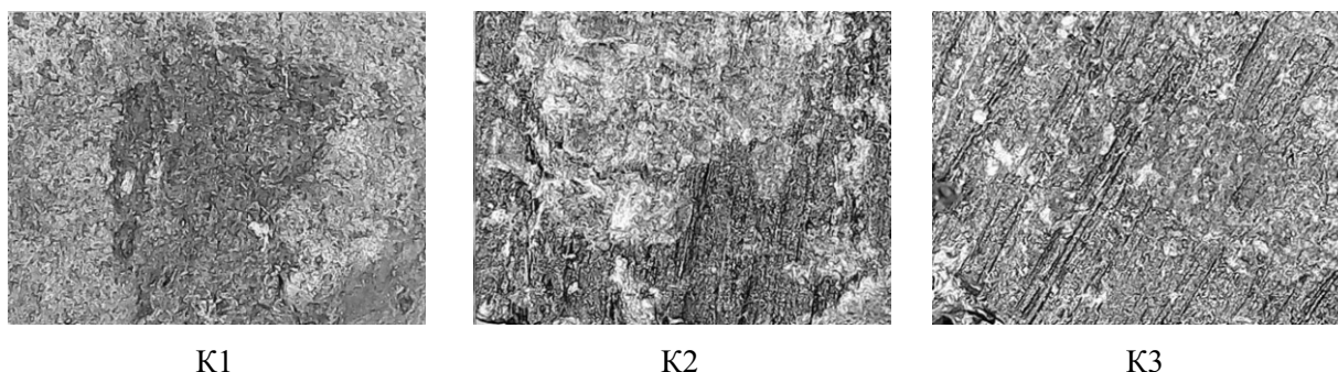
Рис. 3. Микрофотографии сколов образцов ДПКт (увеличение 60х)
